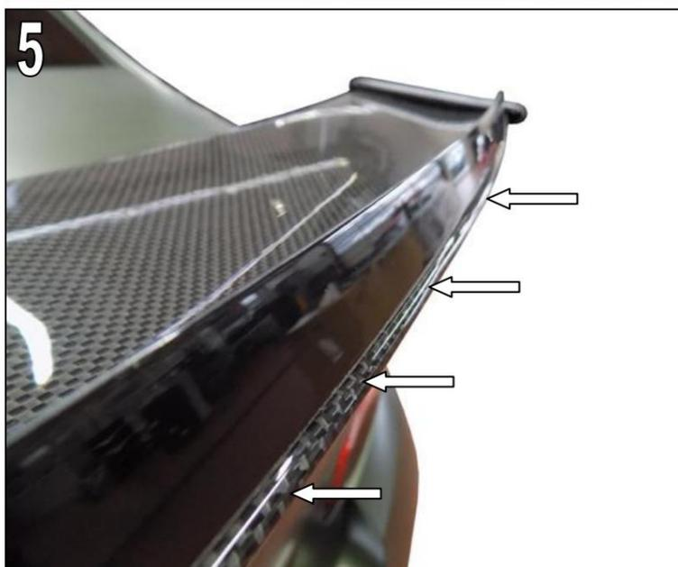
Collez le volet AC Schnitzer Gurney sur l'aile arrière en carbone AC Schnitzer et appuyez fermement.
